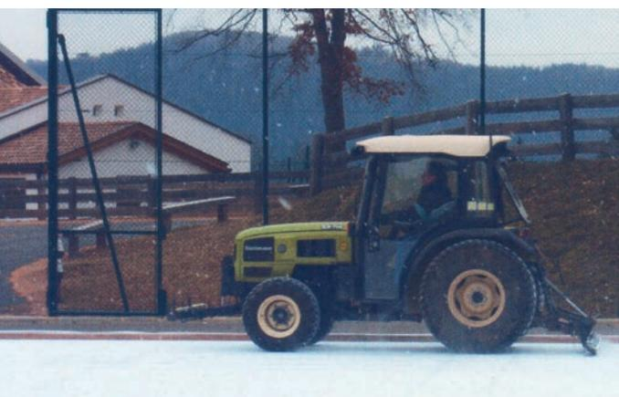
Eisaufbereitung mit dem „Riefgerät“ am Traktor
